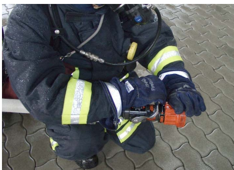
Bild 14: Der Truppmann führt das Rohr mit einer Hand am Bügelgriff und mit einer Hand am Sprühkopf. Der Schlauch klemmt hierbei unter dem Arm oder liegt auf der Schulter. Die Führung des Schlauches übernimmt der Trupfführer.
