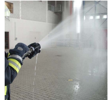
Bild 21: Unbefriedigendes Sprühbild bei 3 bar
